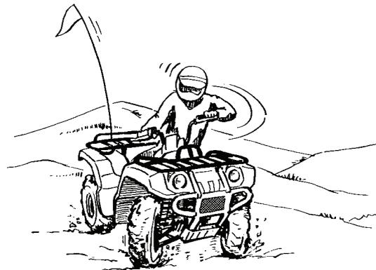
Попрактиковавшись, через некоторое время вы сможете освоить технику контролируемого заноса. Для выполнения таких маневров следует тщательно выбрать подходящий участок, учитывая снижение как управляемости, так и устойчивости мотовездехода. Помните, что маневрирования со скольжением колес следует избегать на особо скользких поверхностях, таких как лед, поскольку мотовездеход может стать полностью неуправляемым.
