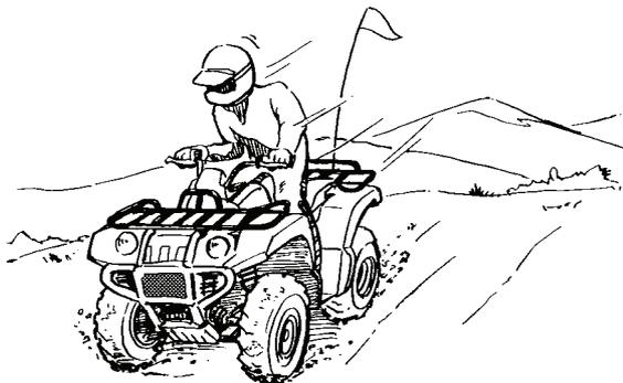
При боковом заносе задних колес мотовездехода управляемость можно восстановить, повернув передние колеса в сторону заноса (при наличии свободного пространства для этого маневра). До тех пор, пока занос не будет устранен, тормозить или увеличивать скорость движения не рекомендуется.
