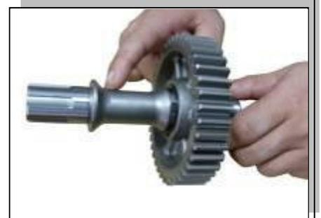
в направлении, противоположном отметке в виде стрелки на роторе. Данная шестерня не должна вращаться в направлении стрелки.
