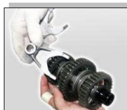
повреждений шестерней, шлицевых соединений, муфте.
