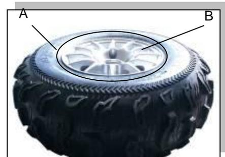
★ Если линии шины и реборды расположены не параллельно, выпустите воздух из шины, смажьте соприкасаемые поверхности еще раз, затем снова накачайте шину.
