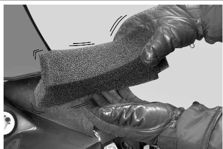
ТИПОВОЙ ВАРИАНТ — СТЯХИВАНИЕ СНЕГА С ФИЛЬТРА
