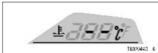
При повышении температуры выше 40°C, дисплей начинает отображать цифровое значение температуры.
