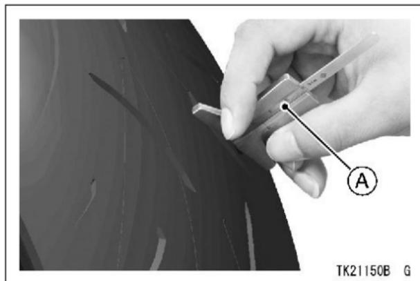
**A.** Измерение глубины протектора щупом
