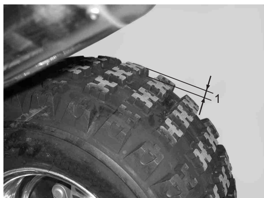
Minimum stud depth (1): 3 mm.
