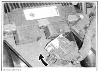
CONNECTOR LOCKING CAM IN RELEASE POSITION
