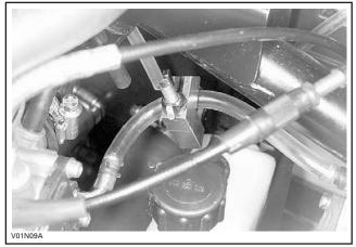
HOSE PINCHER INSTALLED ON FUEL PUMP OUTLET
