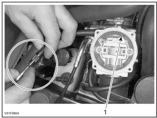
USE CABLE ADJUSTER TO ADJUST PLUNGER POSITION 1. Choke plunger
