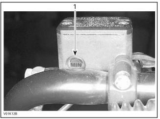
FRONT BRAKE MASTER CYLINDER 1. Indicator level
