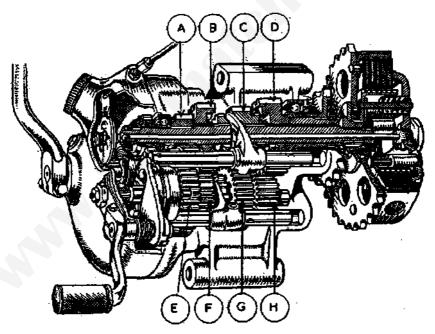
FIG. 28.—CUTAWAY VIEW OF THE B.52 GEARBOX.
