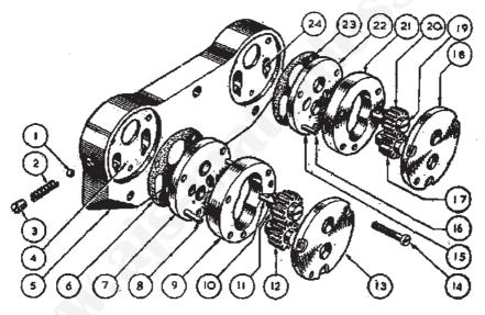
FIG. 2.—EXPLODED VIEW OF THE OIL PUMPS.
