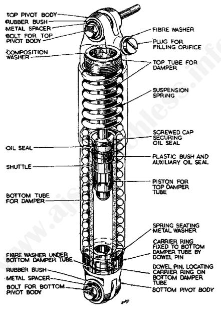
FIG. 34.-THE REAR DAMPER FITTED TO 1950 MODELS.
