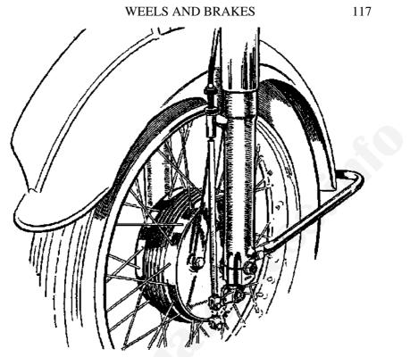
FIG. 43.—FRONT BRAKE ADJUSTMENT.
