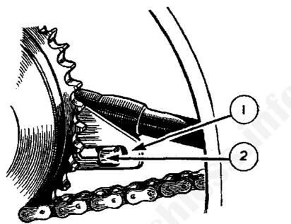
FIG. 40.—REAR BRAKE TORQUE STAY.
