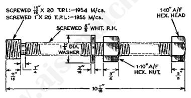
FIG. 30..—DRAW BOLT FOR FACILITATING DISMANTLING AND REASSEMBLY OP FORKS.
