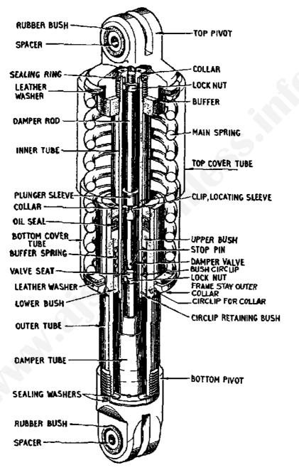
FIG. 35.-REAR DAMPER FITTED TO 1955 MODELS.
