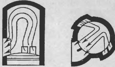
Рис. 24. Схема продувки двигателя
