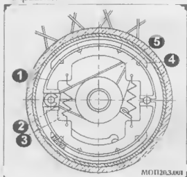
1 — тормозная колодка; 2 — кулачок; 3 — пружина колодок; 4 — тормозная накладка; 5 — тормозной барабан.
