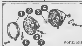
1 — ободок; 2 — стекло-рассеиватель; 3 — лампа; 4 — корпус-рефлектор; 5 — держатель стекла-рассеивателя; 6 — лампа городской езды; 7 — патрон лампы городской езды.
