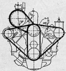
**Рис. 127.** Проверка и регулировка натяжения приводных ремней:
