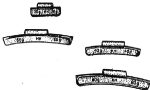
Рис. 221. Свинцовые грузики для балансировки колес
