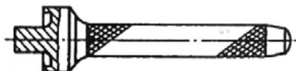
Рис. 176. Оправка для выпрессовки сайлент-блока нижнего рычага
