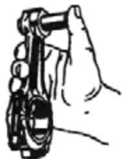
Рис. 18. Проверка правильности подбора поршневого пальца к втулке малой головки шатуна
