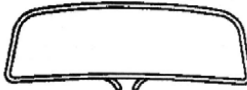
Рис. 320. Установка стекла с уплотнителем в проем
