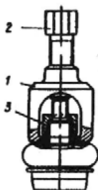
Рис. 215. Съемник шаровых пальцев рулевой трапеции:
