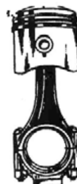
Рис. 16. Взаимное положение поршня и шатуна
