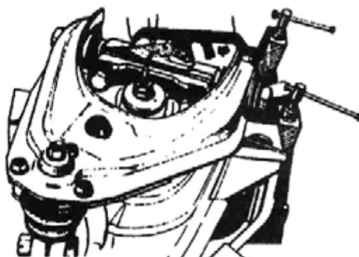
Рис. 184. Установка прокладки для регулировки угла развала колес
