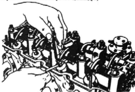
Рис. 39. Проверка теплового зазора клапанов
