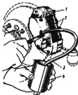
Рис. 254. Удаление воздуха из трубопроводов системы гидравлического привода тормозов:
