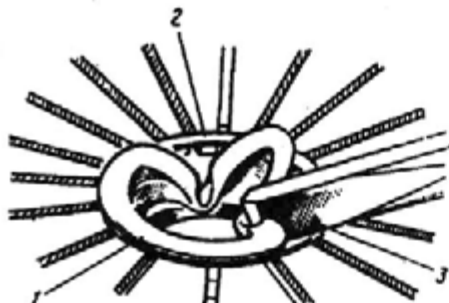
Рис. 80. Удаление центральной втулки крепления опорной пятки:
