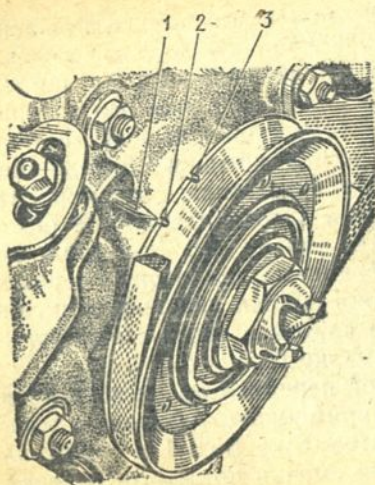
Рис. 35. Установочные метки на ободе ведущего шкива коленчатого вала: 1 — установочный штифт; 2 — метка в. м. т. поршня первого цилиндра; 3 — метка начальной установки момента зажигания
