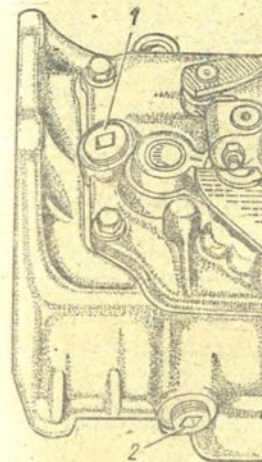
Рис. 32. Пробки отверстий картера коробки передач:
