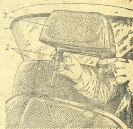
Рис. 14. Спинка сиденья со снятым подголовником:
