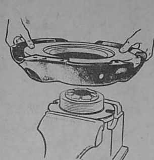
Рис. 42. Установка в тисках основания ремонтного инструмента с фиксирующей оправкой
