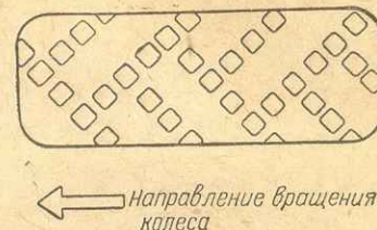
Рис. 91. Направление рисунка протектора шин
