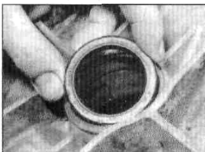
16.6 Установка сальника фланца приводного вала
