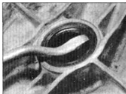
16.5 Снятие сальника фланца приводного вала
