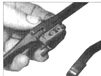
30.5 Отсоединение щетки стеклоочистителя от держателя
