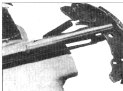
Рис. 9.23 Соединение пружины и тормозного башмака к штанге толкателя (Глава 7)
