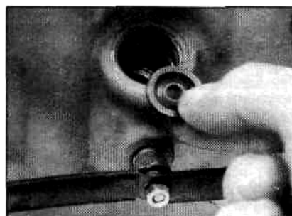
12.1c Извлеките огнеупорные прокладки из отверстий под форсунки
