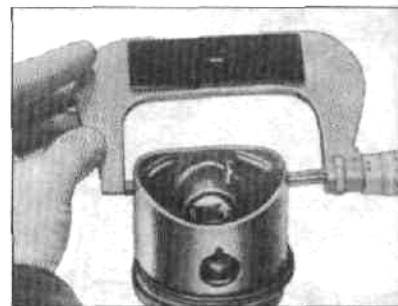
Рис. 1.14 Проверка диаметра поршня (Глава 25)
