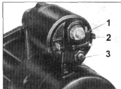
Рис. 10.14 Подсоединение альтернативных связей соленоида стартера на некоторых моделях (Глава 11)
