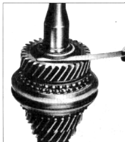
Рис. 6.37 Проверка осевого зазора шестерни 4-ой передачи (Глава 14)
