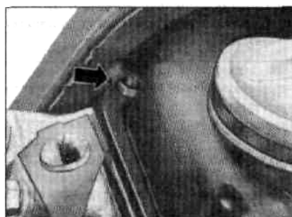
Рис. 1.28 ВМТ на задней поверхности звездочки распредвала, совмещенная с верхней поверхностью прокладки клапанной крышки (Глава 38)
