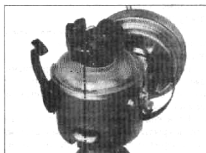
Рис. 4.14 Установите контакт бегунка распределителя на одну линию с меткой на корпусе распределителя (5-ти цилиндровые двигатели) (Глава 8)
