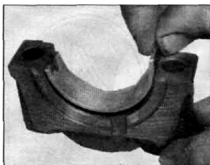
22.21 Установка нового нижнего вкладыша коренного подшипника в крышку
