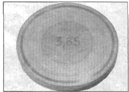
17.7 Выгравированная толщина (в мм) на обратной стороне прокладки толкателя
