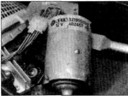
31.4 Двигатель стеклоочистителя и соединители проводки
