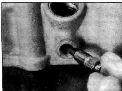
12.1a Снятие свечей накаливания
