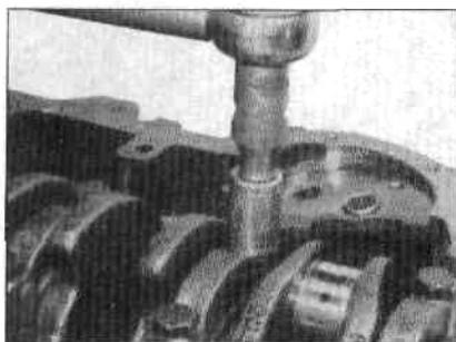
27.10 Сжатие болтов коренной крышки
