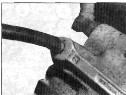
14.9A Соединение трубки прокачки с передним тормозным суппортом
