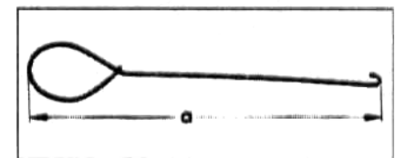
Рис. 12.42 Инструмент для снятия цилиндрической пружины солнцезащитной крыши (Глава 33) a = 300 мм
