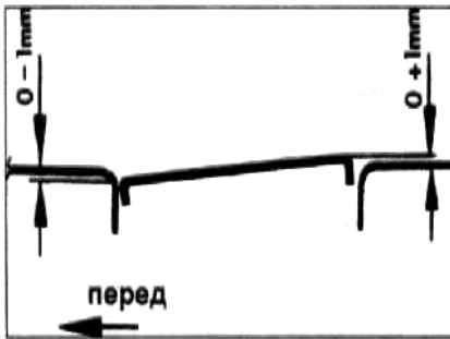
Рис. 12.38 Регулировка высоты люка крыши (Глава 32)
