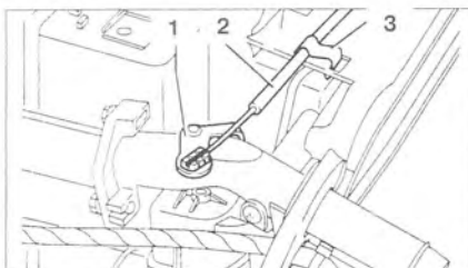
Рис. 9.65. Удерживайте рычаг 1 и присоедините трос 2 с фиксатором 3.
