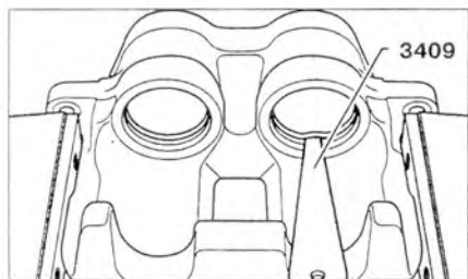
Рис. 8.20. Снимите уплотнительное кольцо с помощью щупа 3409.
