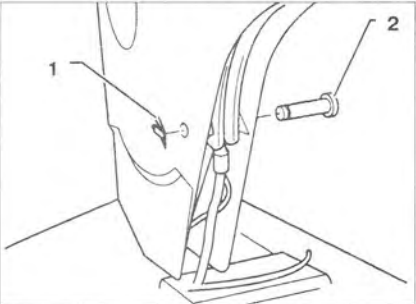
Рис. 8.31. Снимите крепежную плиту 1 и извлеките палец 2.
