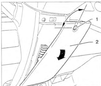
Рис. 7.3. С помощью монеты или отвертки поверните винт 1 на 90° по часовой стрелке. Откройте центральную крышку 2 и снимите ее.
