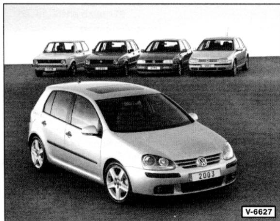
Bei jedem Modellwechsel ist es nahezu zwangsläufig, dass die Karosserie in den Außenabmessungen wächst, und so ist auch der GOLF der fünften Generation gegenüber dem Vorgängermodell etwas größer geworden: Mit 4.204 Millimeter Gesamtlänge übertrifft der GOLF seinen Vorgänger um 55 Millimeter. Bei einer Gesamtbreite von 1.759 Millimeter sind es 24 mm mehr und in der Höhe exakt 41 mm.
