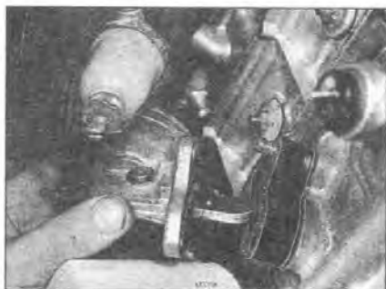
3.7 Снятие насос с фильтром
