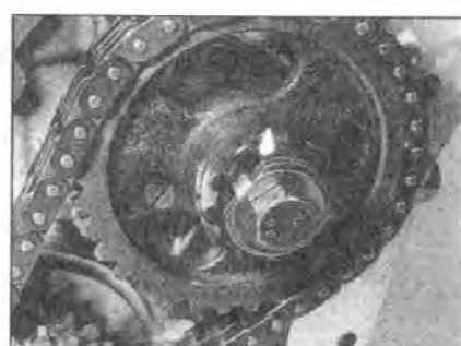
7.20А Убедитесь, что язычок стопорной шайбы правильно располагается в ведущей шестерне...
