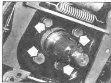
23.4 Монтажные болты опорного щита барабанного тормоза (указаны стрелками)
