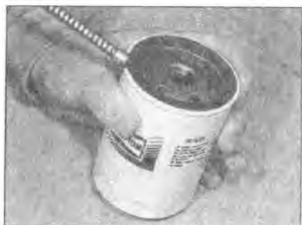
1.15 Перед установкой нового фильтра смажьте кольцевое уплотнение
