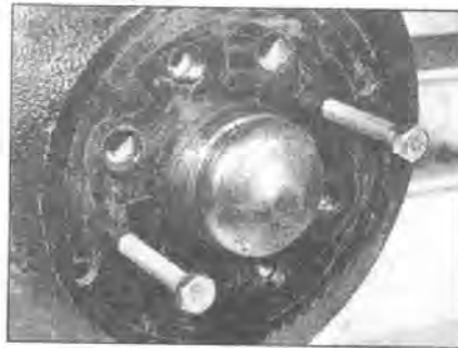
20.4c С помощью двух болтов отожмите барабан от ступицы - зажимайте их равномерно, чтобы избежать повреждения барабана
