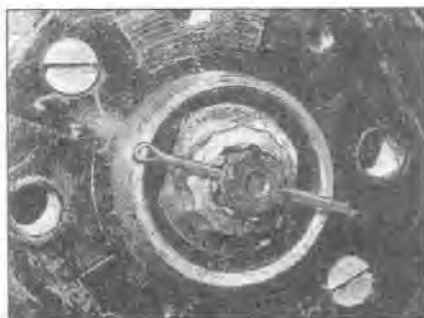
9.14 Закрепите гайку ступицы новым шплинтом
