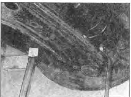
6.9 Зажмите стяжной болт и гайку шарового шарнира нижнего рычага подвески к поворотному кулаку
