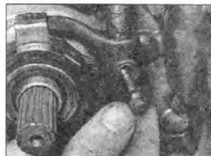
5.8b Совместите отверстия выжимного рычага и вилки выключения сцепления, затем вставьте и зажмите болт крепления
