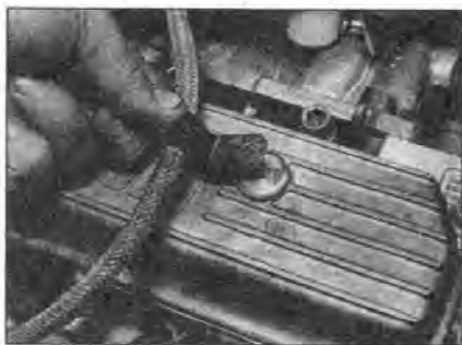
4.3 Освободите крепежную скобу топливного шланга...
