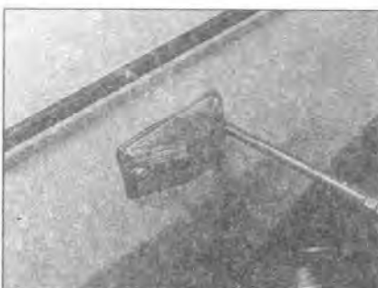
13.13 Снимите рассеиватель бокового повторителя указателя поворота
