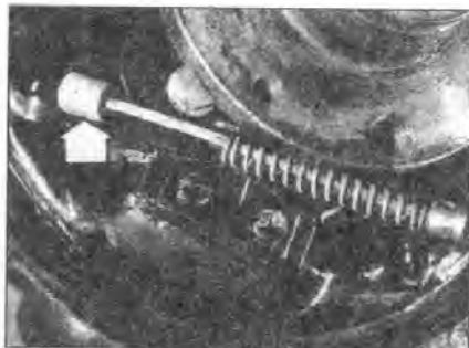
25.7 Кожух тросика ручного тормоза крепится втулкой (отмечена стрелкой) к опорному щиту
