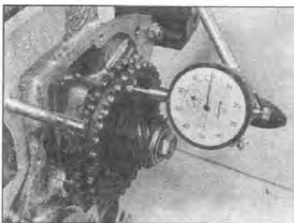
9.6 Проверьте осевой люфт распредвала
