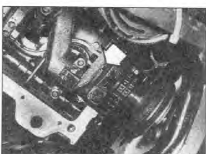
7.24А Убедитесь, что блокирующие язычки упорной шайбы вставлены в прорези крышки подшипника...
