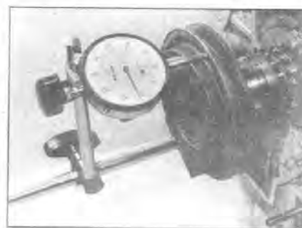
11.4 С помощью микрометра измерьте осевой люфт коленвала
