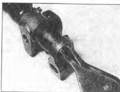
5.4A Чтобы разобрать клапанный механизм, удалите стопорное кольцо...
