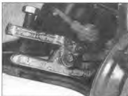
20.4 С помощью универсального съемника отсоедините шаровой шарнир поперечной рулевой тяги от поворотного рычага
