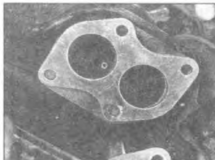
15.7 Установите новую прокладку между фланцем соединения коллектора с отводящей трубой
