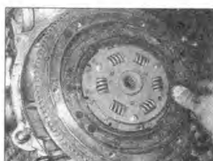
4.4б ... и удалите фрикционный диск, запомнив его правильную ориентацию
