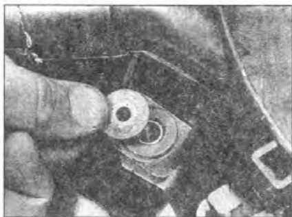
2.2C Снимите крепежную гайку и шайбу фильтра с крепежной детали
