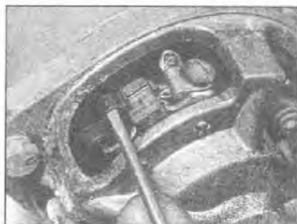
10.3А Откиньте пружину щетки
