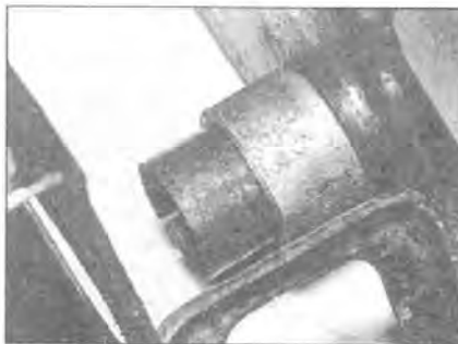
4.8 Шарнирные втулки можно заменить отдельно, если требуется
