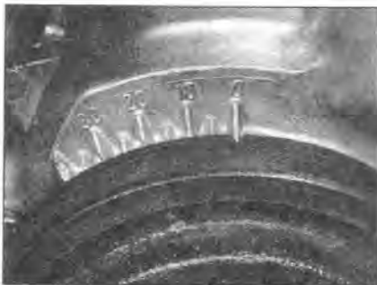
3.6 Метка установки шкива коленвала в ВМТ
