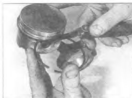
13.7А Измерьте зазор между кольцом и стенкой канавки
