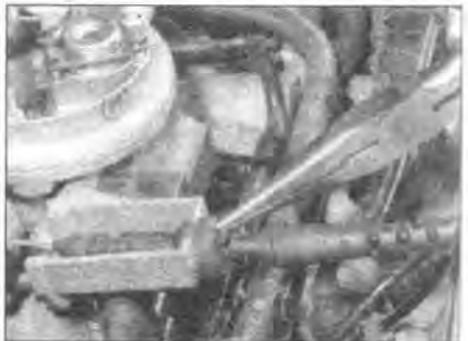
4.8 Отрегулируйте тросик газа, вставляя металлическую скобу в один из пазов в оболочке
