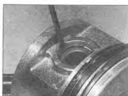
13.1 С помощью маленькой плоской отвертки извлеките стопорные кольца
