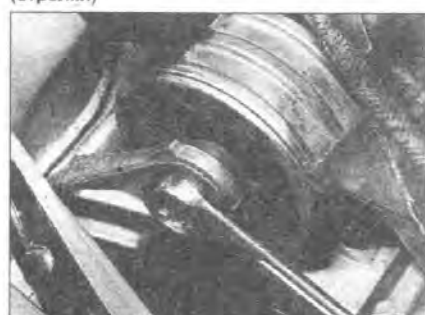
4.21А Ослабьте стяжной болт правого подвеса двигателя/трансмиссии...
