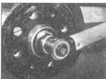
9.11 Зажмите гайку ступицы моментом затяжки, регламентированным Спецификациями
