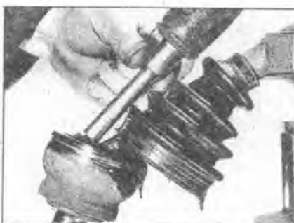
3.4 Сбейте внешний ШРУС с конца приводного вала
