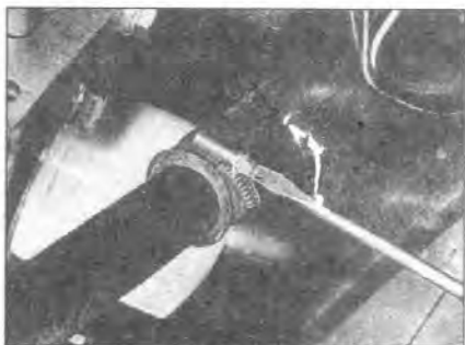
4.14А Отсоедините нижний шланг радиатора...
