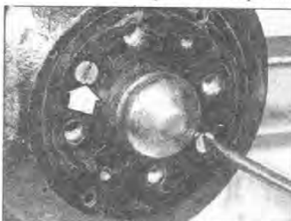
20.3 Снимите винты крепления барабана (один из них отмечен стрелкой)
