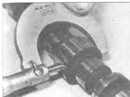
9.10 Измерьте диаметр шейки распредвала
