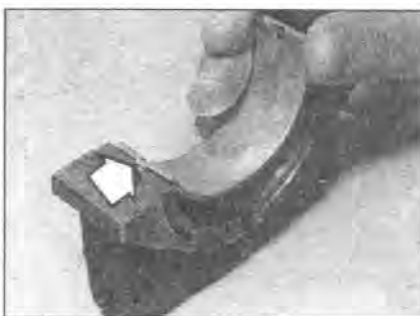
18.5А Нижние коренные вкладыши - сплошные и имеют центральный блокирующий язычок (отмечен стрелкой)...
