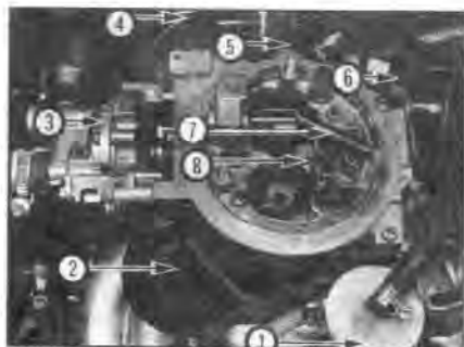
10.1 Общий вид карбюратора 1 Сепаратор газовых пузырей 2 Диафрагма вторичной дроссельной заслонки 3 Кожух автоматической воздушной заслонки 4 Блок Pull-down заслонки 5 Ускорительный насос 6 Термклапан с таймером 7 Отверстие поплавковой камеры 8 Наконечник обогащения предельной нагрузки (камера II)
