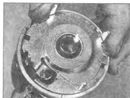
2.17A Извлеките вращающуюся пластину
