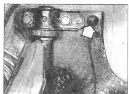
7.9 Поперечина передней подвески располагается на больших выступях (отмечен стрелкой)
