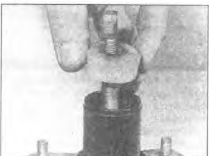
5.6 Воздушный фильтр может быть снят из блока вакуумного усилителя для чистки
