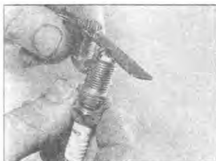
4.16 Измерение межэлектродного зазора свечи зажигания с помощью щупа
