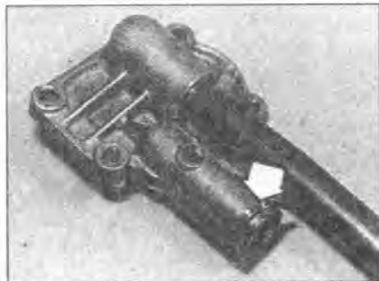
9.5A Извлеките шпильку (отмечена стрелкой)...
