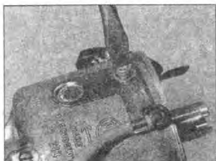
2.15A Открутите винты крепления...
