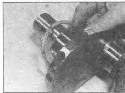
18.20А Установите внутреннюю упорную шайбу на коленвал, смазочными канавками к противовесу...
