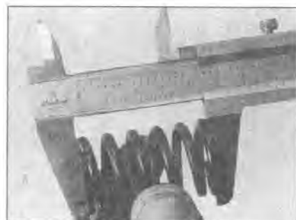
7.16 Измерьте свободную длину пружины клапана
