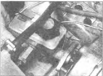
5.3 При снятии главного цилиндра с блока вакуумного усилителя следите за тем, чтобы не погнуть и не повредить тормозные трубки
