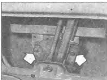
18.3 Болты крепления канала стеклоподъемника (отмечены стрелками)
