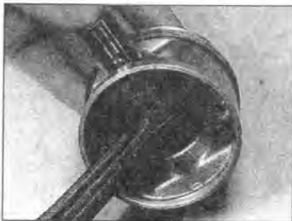
13.12 Совместите поршневой палец с отверстием в верхней головке шатуна, затем вставьте его...
