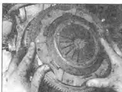
4.4а Снимите с маховика нажимной диск ...
