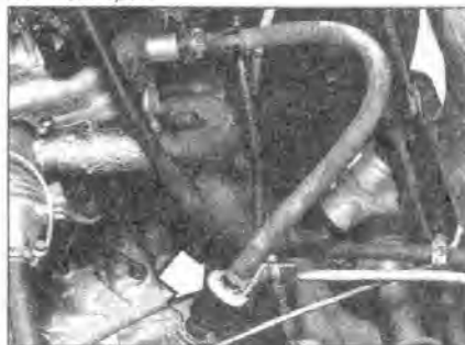
7.1 Невозвратный клапан (отмечен стрелкой) находится в шланге вакуумного усилителя
