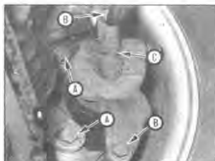
14.4 Болты крепления кронштейна суппорта к поворотному кулаку (А), болты направляющих штифтов (В) и соединительная муфта шланга (С)
