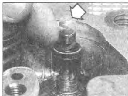
8.2С Аккуратно наденьте маслосъемный колпачок на шток клапана. Заметьте защитную втулку (отмечена стрелкой), которая входит в комплект фирменных колпачков
