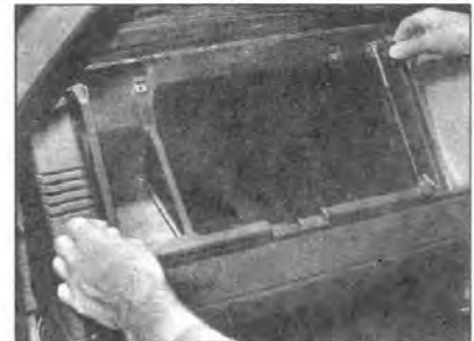
23.3В ...и извлеките бардачок из панели
