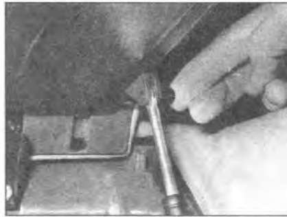
23.1 Снимите поворотную ось опорной стойки бардачка
