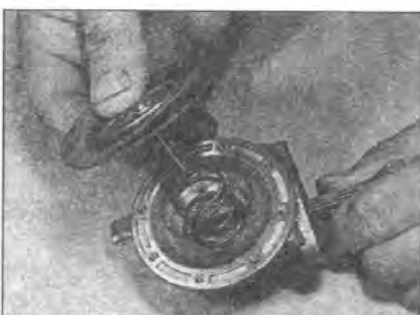
3.10B Снимите диафрагму и пружину
