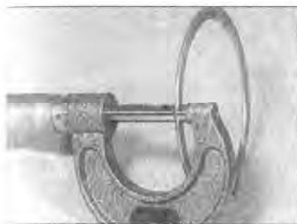
Рис. 2В.9 Измерение толщины упорной шайбы коленвала
