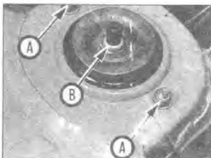
4.3А Гайки верхнего крепления стойки передней подвески (А) и гайка штока поршня (В)
