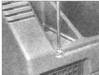
23.3А Открутите винты крепления бардачка...
