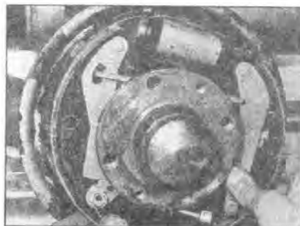
21.14a Снимите сборку колодок ...
