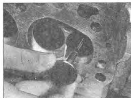
8.1 Смажьте шток клапана, затем вставьте его в направляющую...
