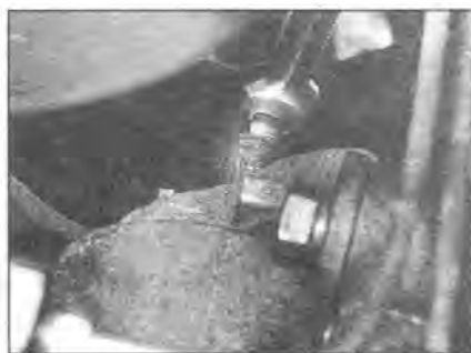
4.22 Ослабьте стяжной болт левого подвеса двигателя/трансмиссии
