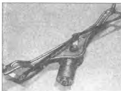
26.12 Сборка тяги и мотора стеклоочистителя. Обратите внимание, что мотор не в «припаркованном» положении
