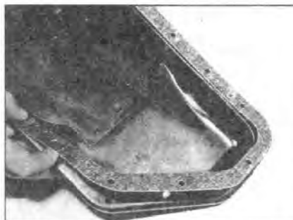
10.9А Установите новую прокладку на поддон...
