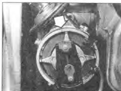
3.7 Когда бегунок распределителя выровнен с надрезом (отмечен стрелкой), поршень №1 находится в положении ВМТ на такте сжатия
