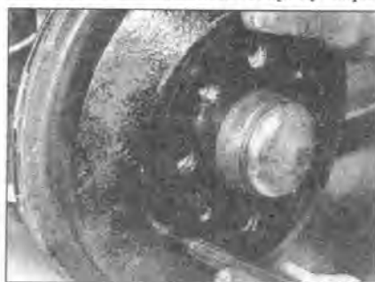
20.4a Чтобы отвести тормозные колодки от барабана, вставьте в его отверстие подходящий стержень ...
