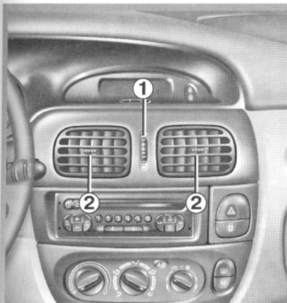
Центральные вентиляционные решетки: передняя и со стороны пассажира
