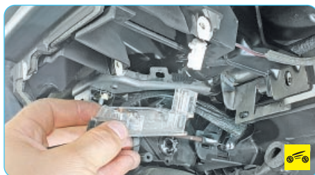
46. ...и отведите в сторону на длину жгута проводов плафон освещения вещевого ящика. Отожмите фиксатор и отсоедините колодку жгута проводов от разъема плафона. Снимите плафон освещения вещевого ящика.
