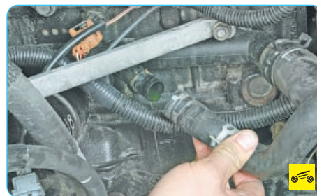
39. ...и отсоедините патрубок от штуцера рукава системы охлаждения.
