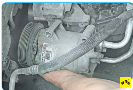
60. Снимите компрессор кондиционера, не отсоединяя трубопроводы, и закрепите его любым способом (см. «Снятие и установка компрессора кондиционера», с. 260).
