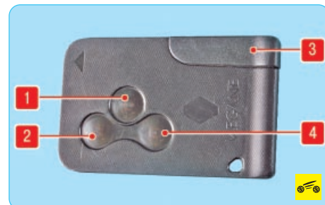
Рис. 1.9. Ключ-карта автомобиля: 1 – клавиша блокировки/разблокировки замка крышки багажника; 2 – клавиша разблокировки замков дверей автомобиля; 3 – запасной ключ; 4 – клавиша блокировки замков дверей автомобиля
