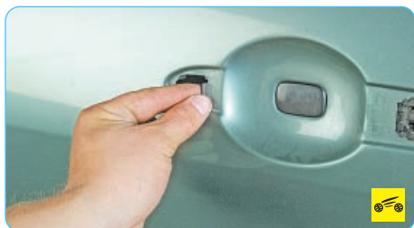
6. Отожмите фиксатор кронштейна крепления наружной ручки к двери и протолкните отверткой кронштейн в полость двери.
