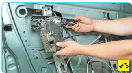
7. Извлеките замок двери в сборе с основанием наружной ручки, вынимая его через технологическое отверстие в панели двери.
