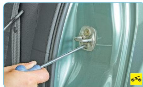
1. Ослабьте затяжку двух винтов крепления защелки и отрегулируйте защелку так, чтобы она была установлена параллельно направлению зацепления защелки замка.
