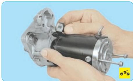
6. ...разъедините крышку и корпус стартера, а затем извлеките опору рычага вместе с резиновой проставкой...
