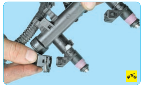
4. ...и отсоедините колодку от разъема форсунки.
