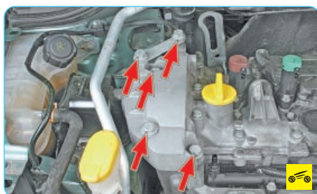
64. Выверните пять болтов крепления правой опоры подвески силового агрегата к двигателю...
