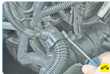
36. Подденьте скобу крепления жгута проводов...
