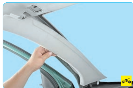
51. Снимите облицовки передних стоек кузова (см. «Снятие и установка облицовок салона», с. 244).
