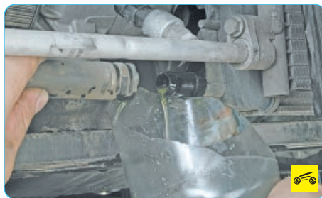
9. Осмотрите соединения шлангов отопителя с патрубками. В случае подтекания охлаждающей жидкости замените хомуты крепления шлангов.
