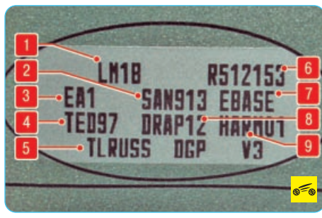
Рис. 1.8. Наклейка с информацией о комплектации автомобиля: 1 – тип автомобиля; 2, 7 – коды специальной комплектации; 3 – уровень комплектации; 4 – код цвета кузова; 5 – техническая характеристика автомобиля; 6 – заводской номер; 8 – код цветовой гаммы интерьера; 9 – код обивки салона
