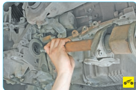
30. Отведите в стороны поворотные кулаки и отсоедините от коробки передач внутренние шарниры приводов передних колес (см. «Снятие и установка приводов передних колес», с. 135).
