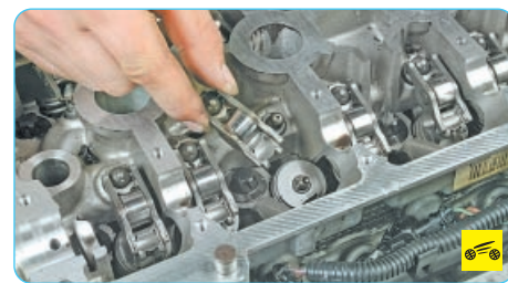
1. Снимите коромысла клапанов.
