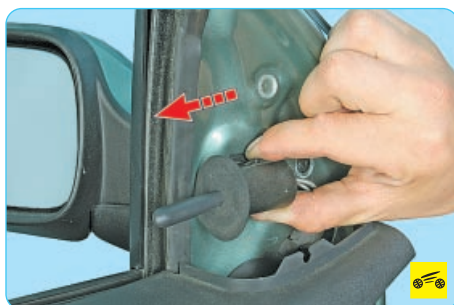
4. Сдвиньте рычаг назад (в направлении стрелки)...
