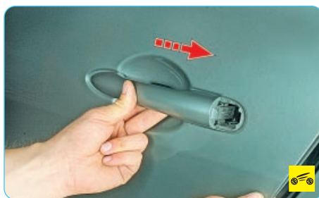
6. Сдвиньте наружную ручку назад (в направлении стрелки)...
