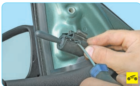
6. Подденьте отверткой фиксатор...
