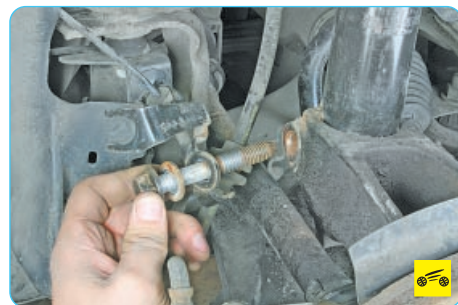
29. Отверните гайки болтов крепления амортизаторных стоек (по одной с каждой стороны) к поворотным кулакам и выньте болты из отверстий кулаков и стоек.
