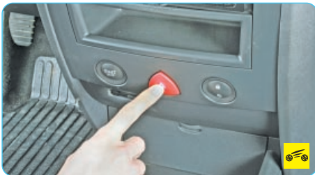
17 – выключатель аварийной сигнализации. При нажатии на клавишу выключателя загораются мигающим светом все указатели поворота и установленные в комбинации приборов сигнализаторы. При повторном нажатии на клавишу сигнализация отключается.
