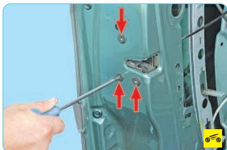
5. Выверните три винта крепления замка к каркасу двери.
