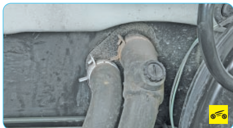
9. Осмотрите соединения шлангов отопителя с патрубками. В случае подтекания охлаждающей жидкости замените хомуты крепления шлангов.
