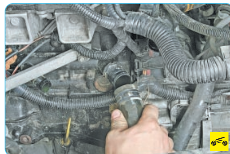
40. Аналогично отсоедините отводящий патрубок радиатора от штуцера рукава системы охлаждения...
