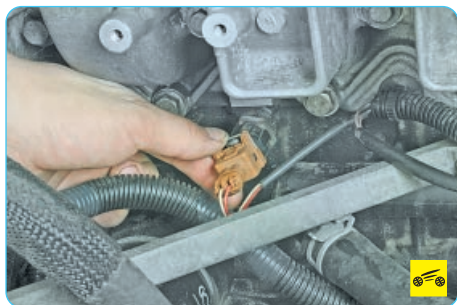
26. Отожмите фиксатор колодки жгута проводов датчика детонации...
