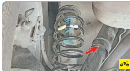
Рис. 7.4. Расположение элементов задней подвески: 1 – продольный рычаг задней подвески; 2 – кронштейн продольного рычага; 3 – тормозной щит; 4 – амортизатор задней подвески; 5 – пружина задней подвески; 6 – буфер хода сжатия; 7 – резиновая прокладка пружины задней подвески; 8 – балка задней подвески; 9 – трубопровод тормозной системы задних колес; 10 – грязезащитный экран
