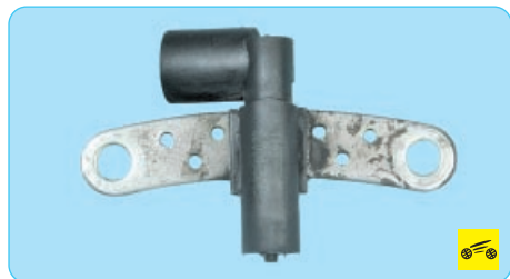
Датчик положения коленчатого вала предназначен для синхронизации работы
