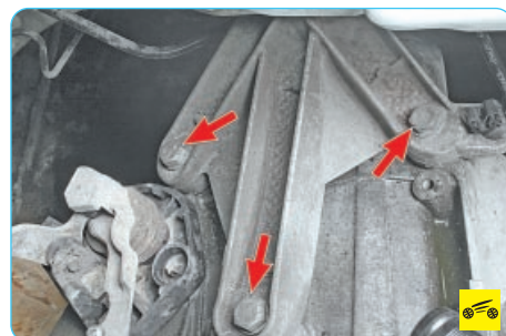
66. Выверните три болта крепления опоры к корпусу коробки передач.
