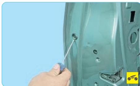
5. Подденьте отверткой и снимите заглушку отверстия в задней части передней двери.
