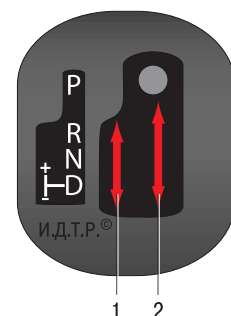
Рис. 1.16. Расположение прорезей для перемещения рычага селектора в накладке тоннеля пола: 1 – прорезь ручного режима управления; 2 – прорезь автоматического режима управления
