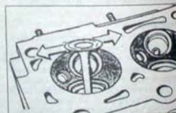
6.4 Измерение люфта клапана в направляющей втулке
