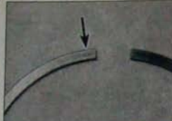
17.10c Где необходимо, проверьте, чтобы кольца были установлены меткой (отмечена стрелкой) вверх
