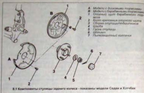
8.1 Компоненты ступицы заднего колеса - показаны модели Седан и Хэтчбек
