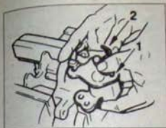
10.27 Установите возвратную пружину рычага ручного тормоза в показанном порядке - модели Седан и Хэтчбек
