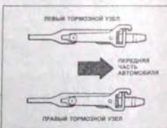
6.17а Ориентация разжимной планки - модели Седан и Хэтчбек
