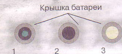
Рис. 1. Показания индикатора плотности электролита: 1 — темный индикатор с зеленой точкой — батарея заряжена; 2 — темный индикатор без зеленой точки — батарея разряжена; 3 — прозрачный или светло-желтый индикатор — низкий уровень электролита
