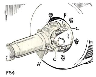
Fig. 26. Propeller shaft lubrication
