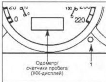
4. Обнуление счетчика пробега, вычисляемого в данный момент на ЖК-дисплее, происходит более долгим нажатием на кнопку (более секунды).
