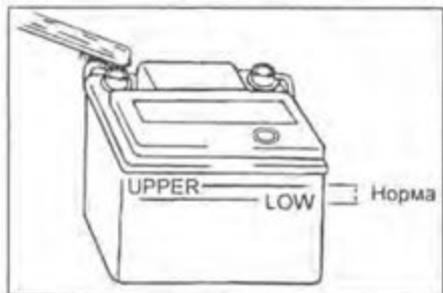
б) С помощью ареометра и термометра измерьте плотность электролита в аккумуляторной батарее.
