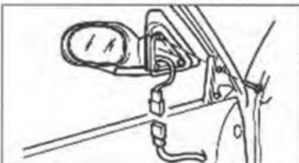
11. Снимите жгут проводов двери через сервисное отверстие двери.
