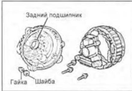
8. С помощью паяльника отпаяйте провода выпрямителя от статора и снимите регулятор напряжения.
