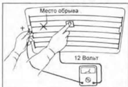
3. Если присутствует обрыв цепи между центральной точкой и отрицательным выводом нагревательного элемента, то вольтметр покажет значение напряжения равное 0 В.
