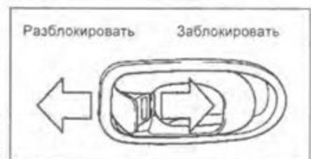
4. На моделях с центральным замком при отпирании/запирании двери водителя ключом или по средствам внутренней кнопки блокировки замка двери, происходит автоматическая блокировка/разблокировка замков остальных дверей, включая замок крышки багажника.
