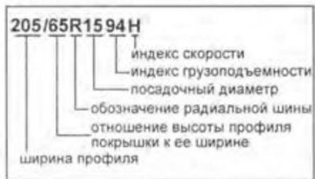
**205** - условная ширина профиля, выраженная в миллиметрах. Данный размер задается заводом-изготовителем.
