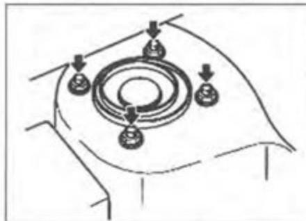
в) Опустите верхнюю опору стойки передней подвески вниз и отрегулируйте развал и продольный наклон оси поворота.
