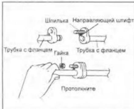
2. Обслуживание трубок и соединений. Внутренние поверхности компонентов системы кондиционирования остаются химически стабильными так долго, сколько используется чистый хладагент без примеси влаги с достаточным количеством компрессорного масла. Наличие внутри системы влаги, грязи или воздуха нарушает химическую стабильность системы и может привести к появлению неисправностей или серьезных повреждений.
