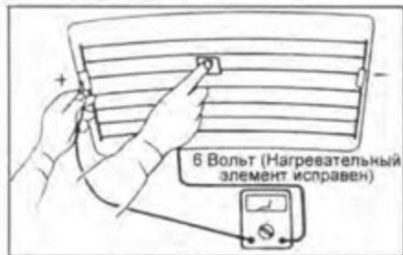
2. Если присутствует обрыв цепи между центральной точкой и положительным выводом нагревательного элемента, то вольтметр покажет значение напряжения равное 12 В.
