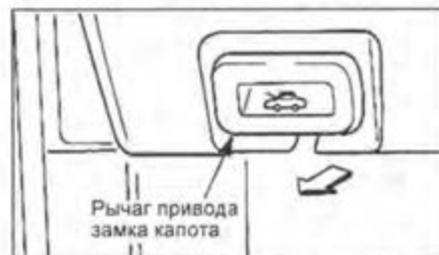
б) Слегка приподнимите капот и потяните рычаг блокировки замка капота, как показано на рисунке.
