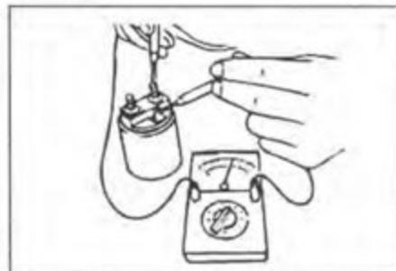
2. Убедитесь в наличии проводимости между выводом "S" и корпусом тягового реле. Если проводимость отсутствует, замените тяговое реле в сборе.
