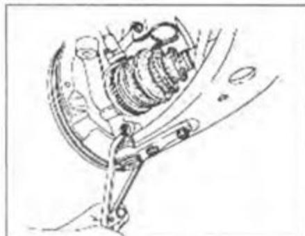
20. Отсоедините левый приводной вал от коробки передач (см. главу "Приводные валы").
