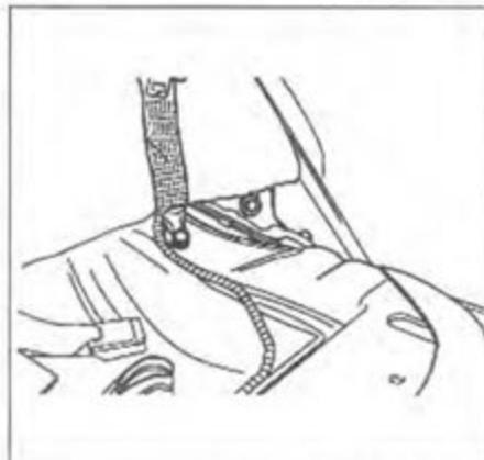
3. Снимите отделку задней стойки.
