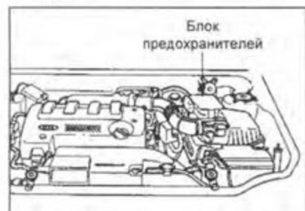
Блок предохранителей в моторном отсеке.
