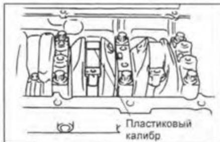
ж) Установите крышку нижней головки шатуна, совместив метки на крышке нижней головки шатуна и на шатуне. Затяните болты/гайки крепления крышки.
