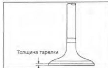
Если толщина цилиндрической части тарелки клапана меньше, то замените клапан.
