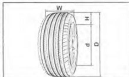
Размеры шин. D - наружный диаметр, d - посадочный диаметр обода колеса, H - высота профиля покрышки, W - ширина профиля.
