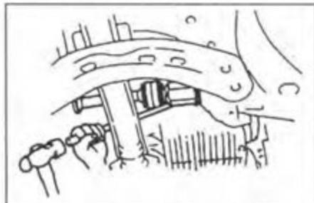
9. Отверните три болта крепления опоры промежуточного вала и вытяните вал.
