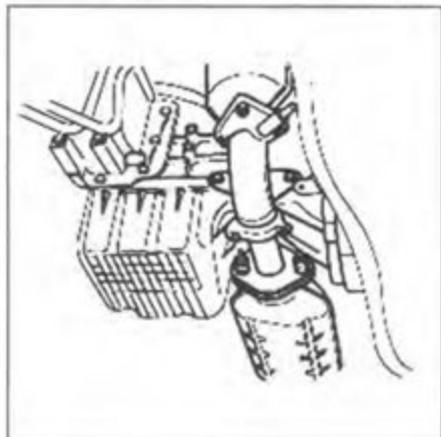
11. Снимите поперечную балку.
