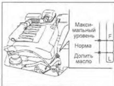
*Внимание:* заливка моторного масла выше максимального уровня отрицательно влияет на работу двигателя.
