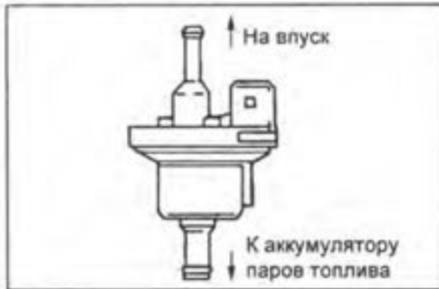
3. Отсоедините разъем клапана и подайте напряжение аккумуляторной батареи на выводы.
