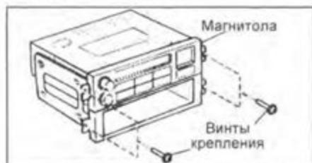
6. Отсоедините разъемы проводки, кабель антенны и снимите магнитолу.
