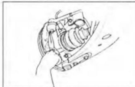
20. Ослабьте гайку крепления стойки стабилизатора к стабилизатору поперечной устойчивости, отверните гайку и отсоедините стойку стабилизатора от стойки передней подвески.
