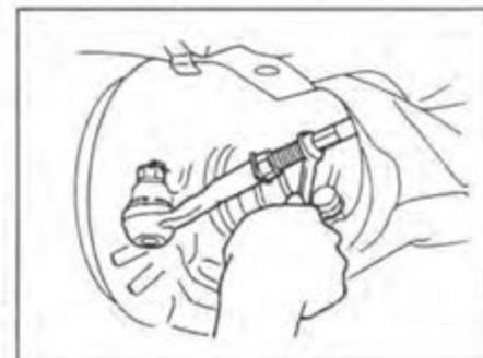
б) Снимите хомут чехла рулевого механизма.
