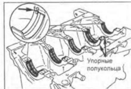
3. Установите коленчатый вал и крышки коренных подшипников коленчатого вала.
