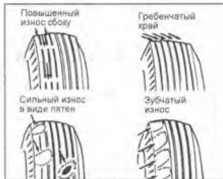
г) Причиной появления сильного износа в виде пятен ("проплешин") на протекторе является дисбаланс колеса.
