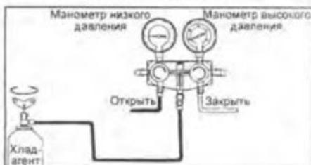
5. Заправьте систему кондиционирования номинальным количеством хладагента. Затем закройте клапан штуцера низкого давления. Если хладагент поступает в систему слишком медленно, то погрузите заправочный баллон в емкость с теплой водой (температура не выше 40°C).
