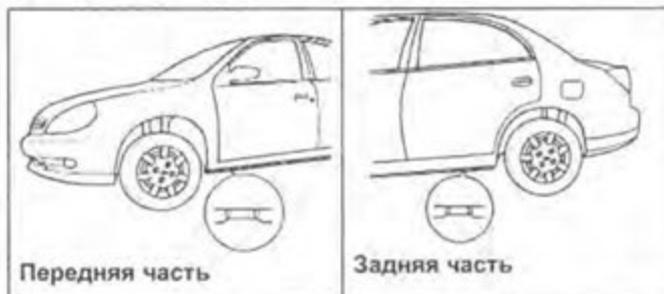
Точки установки предохранительных стоек и лап подъемника.
