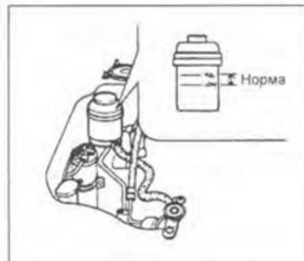
2. Проверка гидросистемы усилителя рулевого управления.
