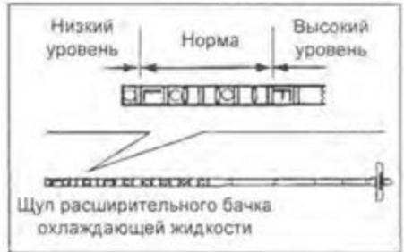
2. Проверьте качество охлаждающей жидкости.
