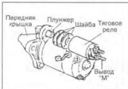
2. Отверните винты и снимите тяговое реле.
