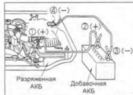
4. Запустите двигатель обычным способом. После запуска он должен работать в режиме 2000 об/мин в течение нескольких минут.
