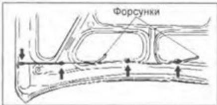
3. Отсоедините фиксатор шланга омывателя расположенный в месте указанным на рисунке, отсоедините шланг от электродвигателя омывателя и снимите его.
