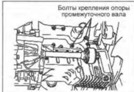
Болты крепления опоры промежуточного вала
