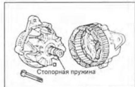
4. Установите ротор в тиски, ослабьте гайку и снимите шкив, ротор и переднюю крышку.
