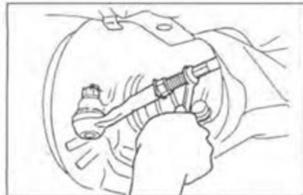
г) Затяните контргайки наконечников рулевых тяг.
