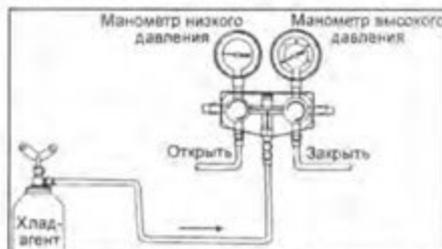
3. Поместите заправочный баллон в емкость с теплой водой (температура не выше 40°C) для создания давления газообразного хладагента в баллоне, немного превышающего давление хладагента в системе.
