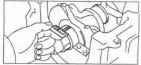
Если масляный зазор больше максимального, замените подшипники. При необходимости перешлифуйте или замените коленчатый вал.
