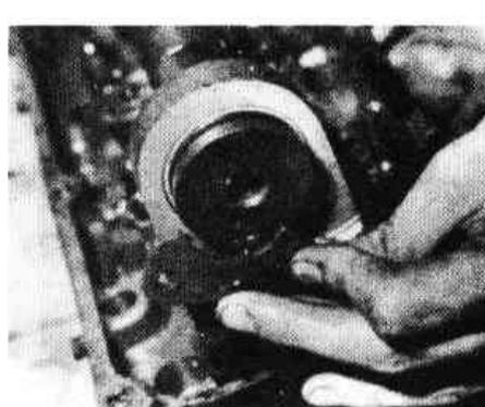
20.6. Снятие упорной пластины распределительного вала
