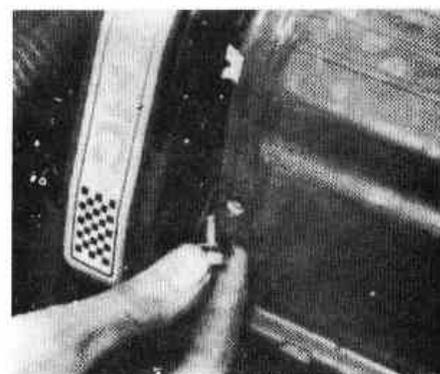
10.22А. Вывинчивание передних болтов крепления верхней крышки
