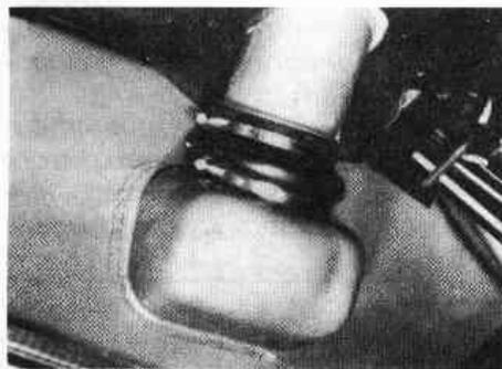
9.6. Снятие резиновой муфты заливной горловины топливного бака
