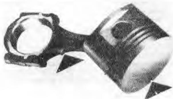
Рис.1Б.14. Размещение маркировки на днище поршня (надрез указывает вперед) относительно отверстия для пропуски масла на шатуне (Разд.45)
