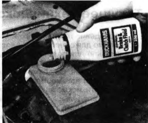
Доливка тормозной жидкости
