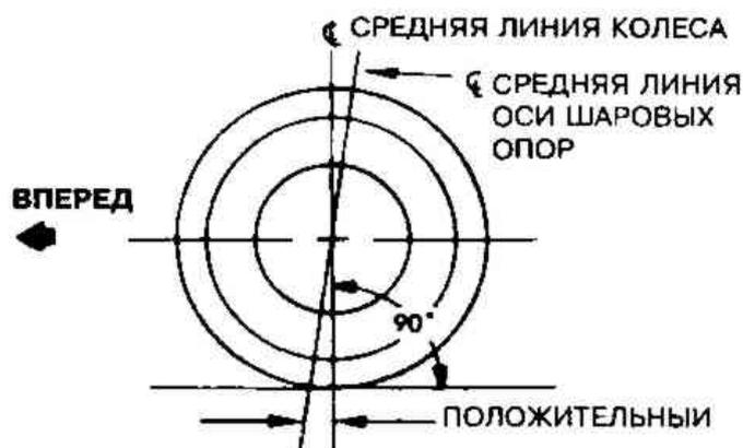
Рис. 11.19. Схема измерения угла наклона оси поворота колес (Разд. 23)
