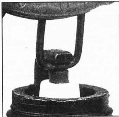
24.4a Фирмы-изготовители свечей зажигания рекомендуют использовать для определения величины свечного зазора измерители проволоочного типа - если измерительный элемент не проскальзывает между электродами свечи с легким сопротивлением, значит, требуется регулировка зазора
