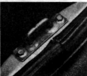
13.26В. Крепление распорки заднего борта на кузове.
