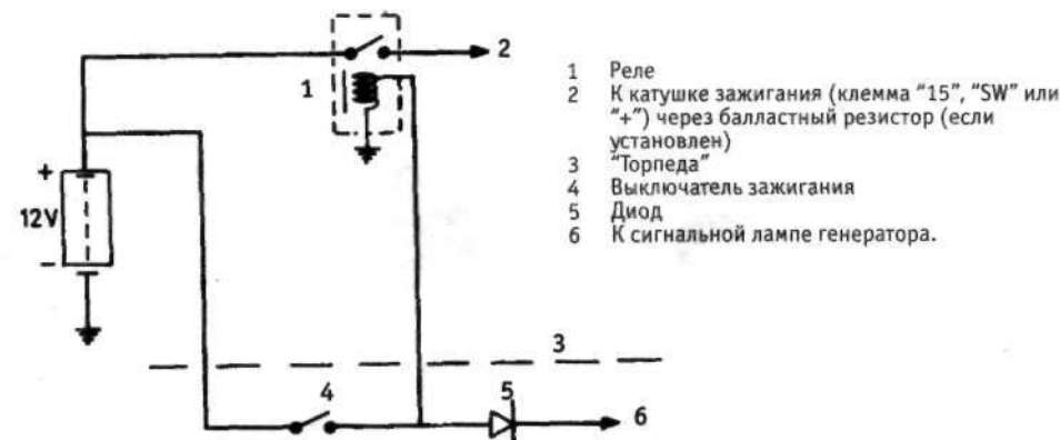
Рис.13.51. Реле катушки зажигания, используемое для подавления помех, возникающих при прохождении электромагнитных волн через корпус радиоприемника/автомагнитолы (раздел 11):
