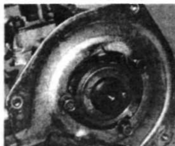
3.54. ...и затем установить опорный щиток кожуха приводного ремня.
