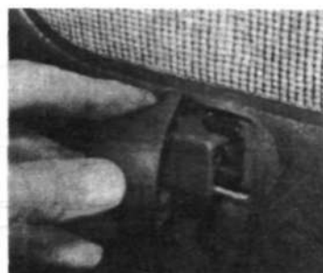
13.10. Снятие облицовки внутренней дверной ручки.
