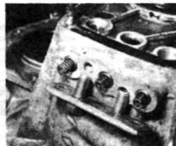
3.6 Высвобождение стопорной пластины, пружин и шариков
