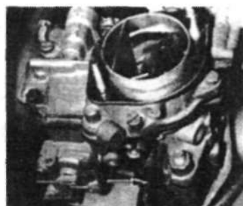
5.21. Однокамерный карбюратор Weber (вакуумная трубка показана стрелкой).
