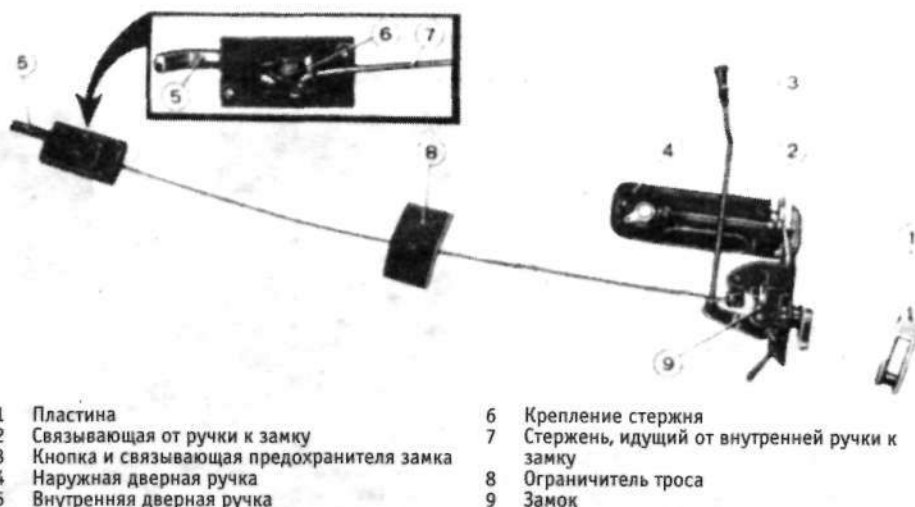
Рис. 12.3 Конструкция дверного замка и контроля
