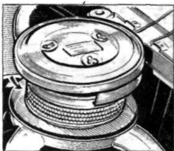
Рис.12. Заменить воздушный фильтр.
