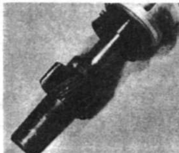
3.64. Косозубая шестерня валика трамблера.
