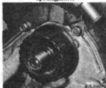
3.47. ...и затем зубчатый шкив коленвала.
