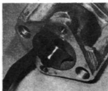
3.24. Измерить зазор между наружным ротором и корпусом насоса...
