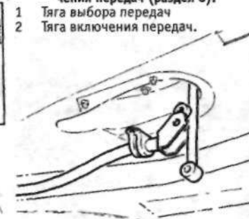
Рис.13.31. Отсоединение верхней тяги механизма переключения передач на моделях с 5-ступенчатой коробкой (раздел 8).
