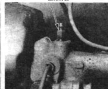
10.7. Спускной ниппель на цилиндре тормозного сервоусилителя (показан стрелкой).
