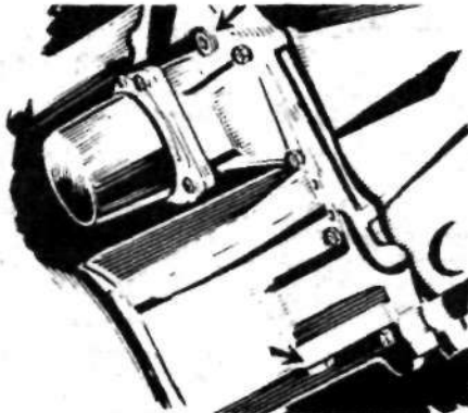
Рис.16. Заменить масло в коробке передач.
