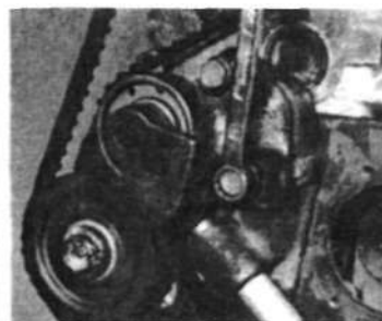
3.78. Регулирование натяжителя приводного ремня.
