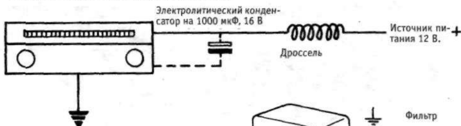
Рис.13.42. Подавитель радиопомех, установленный на питающей линии радиоприемника (раздел 11):
