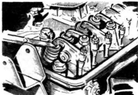
Рис.15. Отрегулировать клапанные зазоры.
