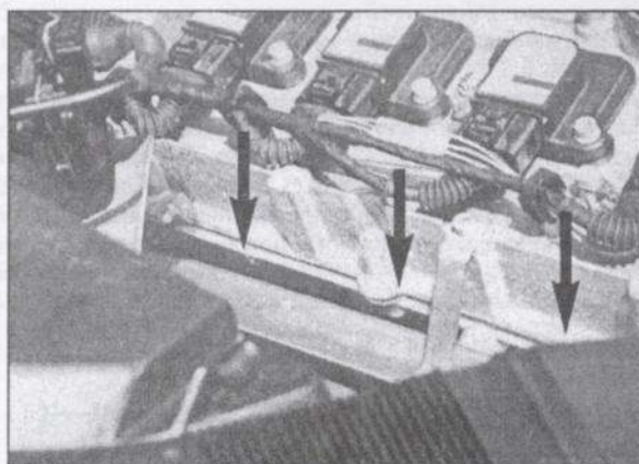
Выпотевание масла в районе прокладки крышки головки блока цилиндров (стрелки), как правило, не является поводом для беспокойства
