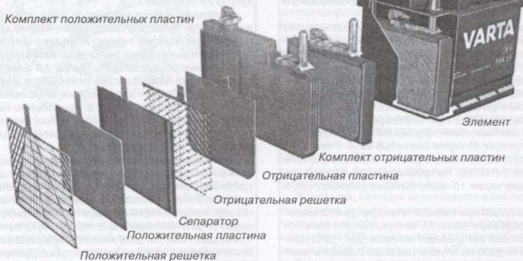
Аккумулятор энергии: внутренние детали 12-вольтовой батареи
