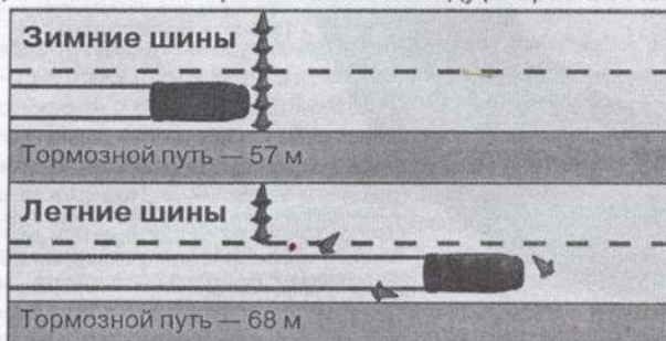
Сравнение картин торможения с летними и зимними шинами (автомобиль без антиблокировочной системы)
