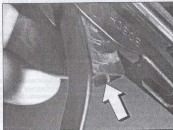
Замена щетки стеклоочистителя: Сначала откиньте рычаг стеклоочистителя, затем деблокируйте шарнир щетки у небольшого язычка (стрелка). После этого щетку можно вытащить из рычага стеклоочистителя
