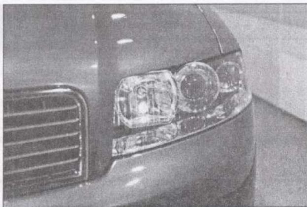
Фара Audi A4: за прозрачным стеклом размещается несколько рефлекторов
