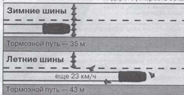
Сравнение картин торможения с летними и зимними шинами (автомобиль с антиблокировочной системой)
