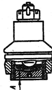
Рис. 193. Предварительная проверка износа шарнира:
