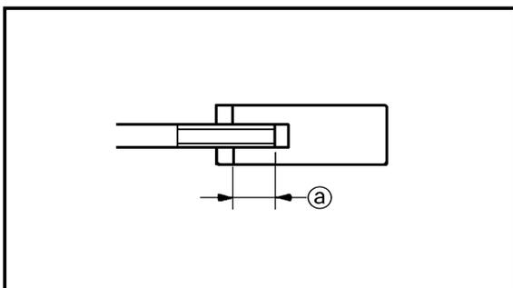
**Shift cable (jet pump side) installation**
