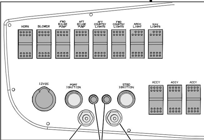
12-VOLT DC IGNITION PUSH-TO-RESET CIRCUIT BREAKERS
